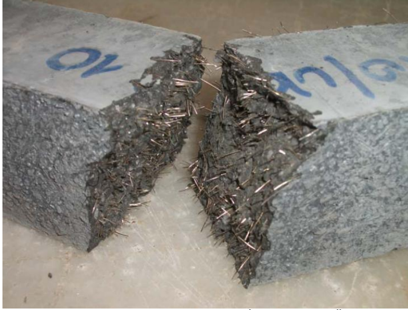
Şekil 4. Reaktif Pudra Betonundan İmal Edilmiş Örnek
